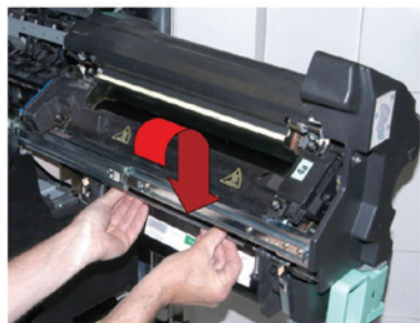
Figuur 7. Klik de papierdoorvoeras in de uitsparingen van het fuserframe.
